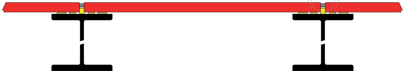
PANNELLO PER PAVIMENTO BALCONI FISSATO NASCOSTO SU TRAVE IN ACCIAIO (INCOLLAGGIO)
