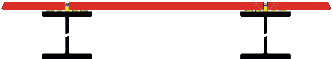
BALKONBODENPLATTE AUF STAHLTRÄGER VERDECKT BEFESTIGT (GEKLEBT)
