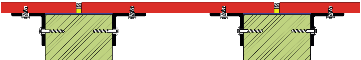
BALKONBODENPLATTE AUF HOLZTRAM VERDECKT BEFESTIGT (GESCHRAUBT)
